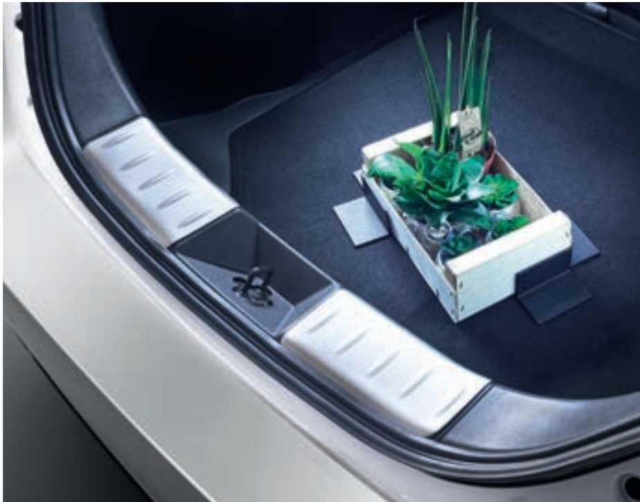
Ladekantenschutz innen – 3D Zum Schutz vor Beschädigungen.
